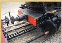
Detalhe do trilho de cremalheira e do engate da locomotiva. Museu Imperial.
